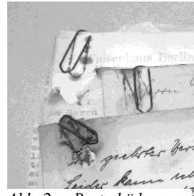
Abb. 2: Rostschäden durch Büroklammern
